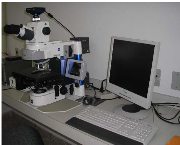
Figura -2: microscópio utilizado para fazer contagem de traços de fissão em apatita e zircão.
